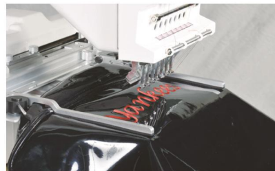
Side Clamp Frame (140×220mm) 包夹具(140×220毫米)
